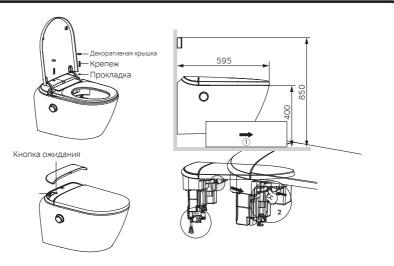
После установки сиденья унитаза на керамики, затяните его крепежным винтом и установите декоративную крышку. После установки извлеките упаковку в направлении стрелки ① на рисунке. Пульт дистанционного управления установлен на расстоянии около 850 мм от земли, что позволяет пользователям легко снимать его.
