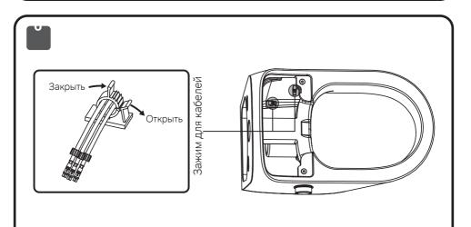
После того, как провод подсветки, провод ручки-регулятора и микроволновый индукционный кабель соединены, расположите провода и вставьте их в зажим для проводов, а затем нажмите и удерживайте зажим для проводов в направлении закрытия, указанном стрелкой. Когда вам нужно вынуть провод, нажмите на зажим для провода в направлении открытия, указанном стрелкой.
