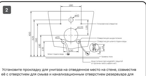
Установите прокладку для унитаза на отведенное место на стене, совместив её с отверстием для смыва и канализационным отверстием резервуара для воды. Пропустите шланг подачи воды через отверстие. Шнур питания пройдет через отверстие для шнура питания, вскрытое в стене.
