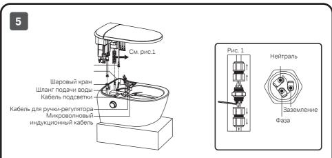
Установите соединительный кабель питания, кабель подсветки, кабель ручки и микроволновый индукционный кабель, как показано на рисунке. Примечание: При подключении необходимо разобрать верхнюю часть водонепроницаемого штекера, проверить, соответствуют ли провод заземления, нейтральный провод и фаза на обоих концах друг другу, и правильно подсоединить провод питания.
